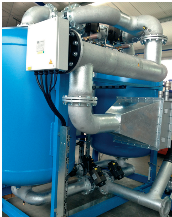
(Bild 2) Die Option LOOP Kühlung für tropische Umgebungen und garantierte Drucktaupunkte von -70^{\circ}\text{C} .
