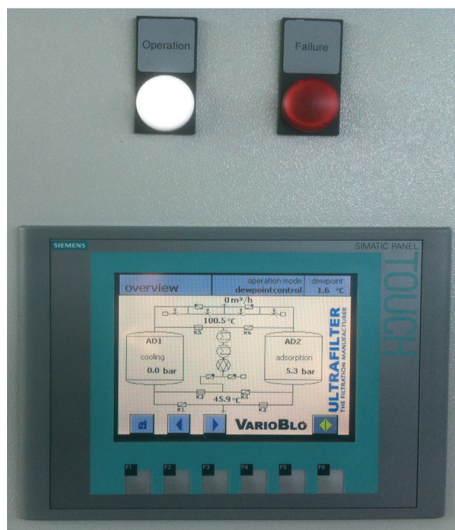
(Bild 4) Ein Touch Panel sorgt für Transparenz und gibt dem Anwender auf einen Blick alle benötigten Informationen über den Betriebszustand des Trockners
